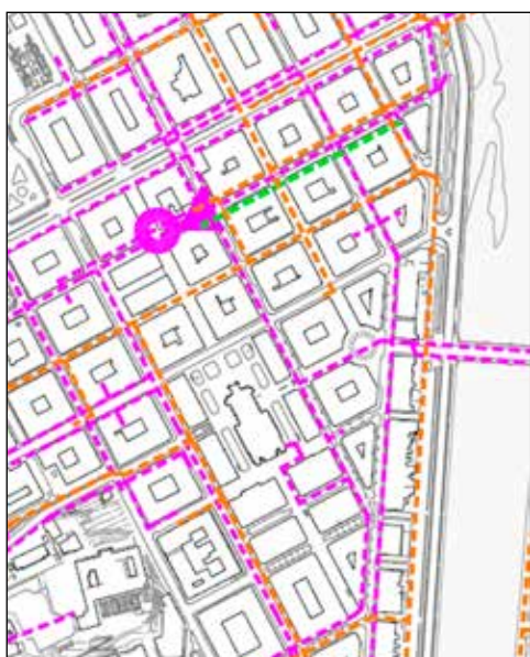
Red de telefonía del Ensanche de Cortázar: Rosa: C. Telefónica. Naranja: Euskaltel. Verde: Jazztel (Orange). Fuente: Plan General de Ordenación Urbana, 2010.
