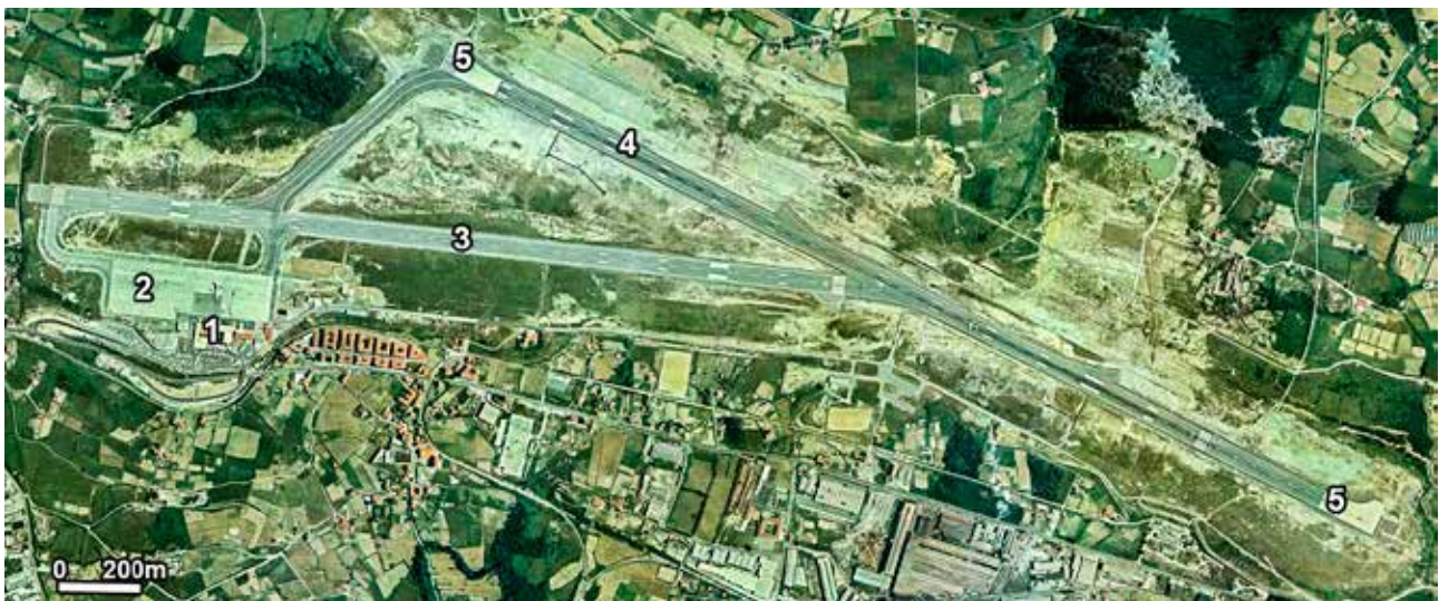
Ortofoto 1983. El aeropuerto tiene ya las dos pistas, pero todavía no está construida la nueva terminal ni la pista de rodadura, razón por la que tiene todavía las plataformas de giro. 1 Terminal. 2 Plataforma de estacionamiento sur. 3 Pista 10/28 (pista antigua). 4 Pista 12/30. 5 Plataformas de giro. Fuente: Eusko Jauraritza / Gobierno Vasco; geoEuskadi. Diputación Foral de Bizkaia.
