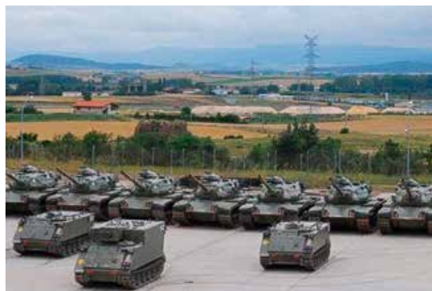
Formación de carros en el interior de la base de Araka. Los tres primeros vehículos son TOAs (Transporte Oruga Acorazado); el primero es un vehículo de mando. La última fila está formada por los carros de combate M48 A5E.
