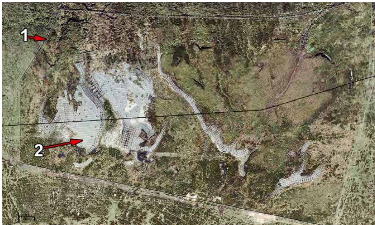
Ortofoto 2015. Fuente: Eusko Jaurlaritza / Gobierno Vasco; geoEuskadi. UTM 30N ETRS89 // X: 466625.3352 // Y: 4775815.4011 // Z: 1329 m Se aprecia la turbera vallada (1), para que no entre el ganado ni los vehículos y protegida la zona erosionada mediante una malla geotextil reforzada por troncos formando cuadrados de 2 m de lado (2).
