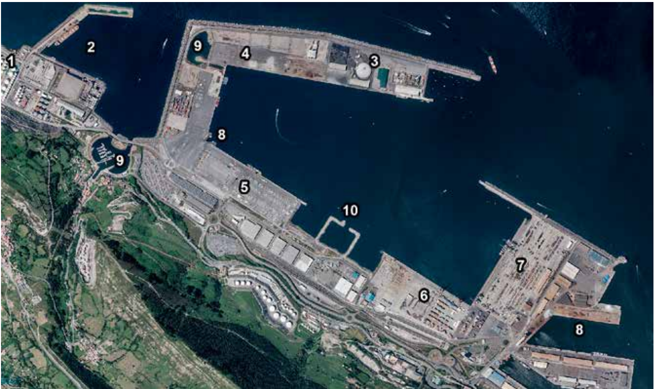
Ortofoto 2015. Fuente: Eusko Jaurlaritza / Gobierno Vasco; geoEuskadi. 1 graneles líquidos (vista parcial) 2 Graneles sólidos. 8 muelles del puerto exterior, dedicados principalmente a carga general. La nueva dársena del "Superpuerto" está ya muy avanzada, con muelles para contenedores (7), graneles sólidos (3), RO-RO, es decir cargamento sobre ruedas (8), contenedores (7) y mercancía general (4). Aún faltan algunas zonas (9) por concluir la construcción de la dársena, siendo especialmente importante la construcción de una superficie perpendicular (10) que dividirá parcialmente en dos la gran dársena, ampliando notablemente la longitud de atraque de los muelles.
