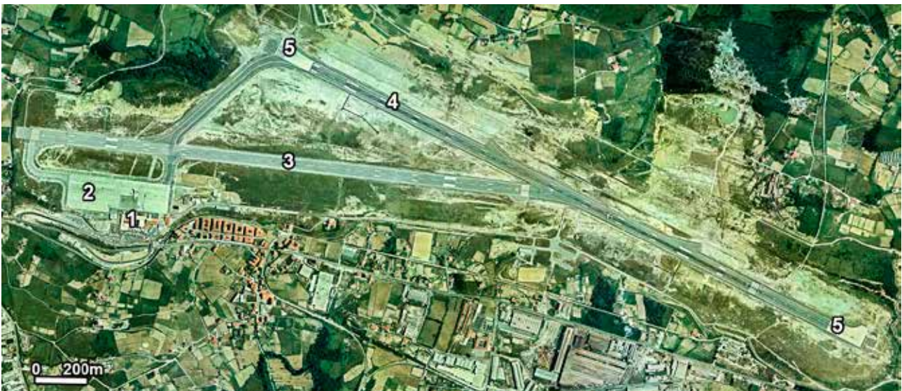
Ortoargazkia 1983. Aireportuak, dagoeneko bi pistak ditu, baina oraindik ez da eraiki ez terminal berria ez errodadura pista, horregatik biraketa plataformak ditu oraindik. 1. Terminala. 2. Hegoaldeko aparkaleku plataforma. 3. 10/28 pista (pista zaharra). 4. 12/30 pista. 5. Biraketa plataformak. Iturria: Eusko Jaurlaritz / Gobierno Vasco; geoEuskadi. Bizkaiko Foru Aldundia.
