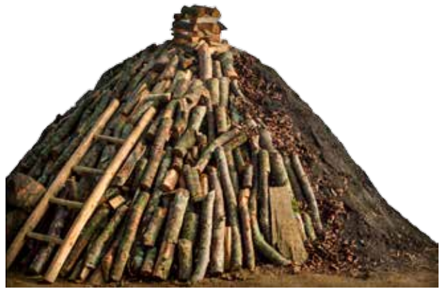
Txondor baten berreraikuntza. Ezkerraldeko sektorean, lurrez estali gabe, ikus daiteke lodiagoa den egurra estaltzen duen egur mehearen antolaketa. Eskailera erabiltzen zen ikazkina tiro lanak egiten zituen tximinia kokatua zegoen goi aldera igo ahal izateko.
