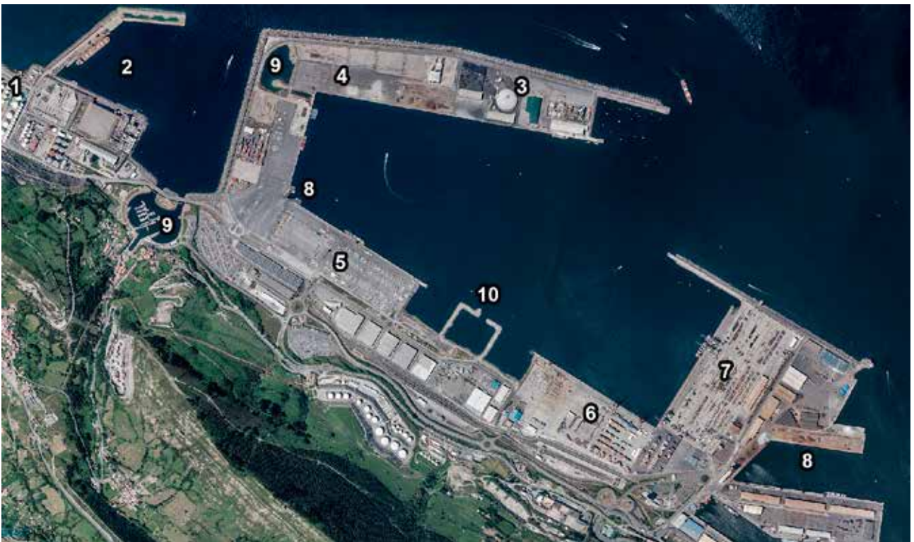
Ortoargazkia 2015. Iturria: Eusko Jaurlaritz / Gobierno Vasco; geoEuskadi. 1. Solteko likidoak (ikuspegi partziala) 2. Solteko solidoak. 8. Kanpo portuko moilak, bereziki zama orokorrerako erabilia. “Superportuko” dartsena berria oso aurreratuta dago, edukiontzietarako (7), solteko solidoetarako (3), RO-RO, hau da gurpilen gaineko kargamendurako (8), edukiontzietarako (7) eta merkantzia orokorrerako (4) moiletarako. Oraindik zenbait guneren (9) dartsena amaitu gabe dago. Bereziki garrantzitsua da dartsena handia partzialki bitan zatituko duen azalera zut baten eraikuntza (10), moiletako atrakalekuen luzera nabarmen handituz.
