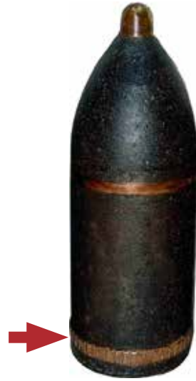
Banda de forzamiento de una granada disparada por un obús de bronce comprimido de 21 cm (Plasencia). Se aprecian los surcos dejados por el estriado. Los proyectiles sin disparar carecerían de surcos.
