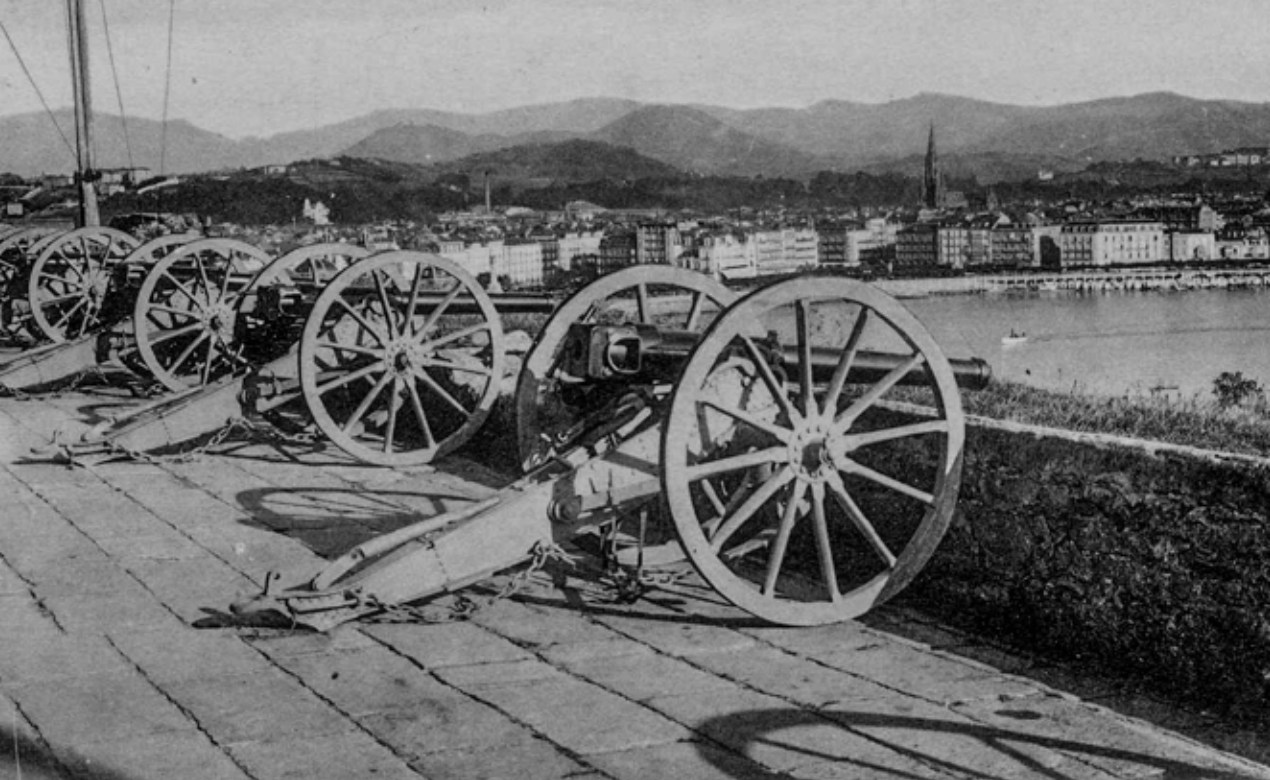
Batería de las Damas, artillada con cañones de acero de 8 cm largo, sobre cureña de chapa mod. 1880
