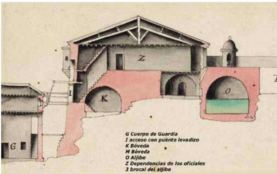
En la sección se aprecia el aljibe "superior".
