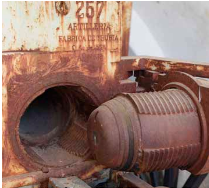
Obús de Acero 155/13 fabricado bajo licencia Schneider en la Fábrica de Trubia en 1939. Se aprecia el cierre con sus sectores lisos y rayados.
