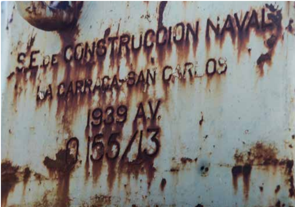
Inscripción en un Obús de Acero 155/13 fabricado bajo licencia Schneider ,en este caso por la Sociedad Española de Construcción Naval -La Carraca-San Carlos (Cádiz) en el año 1939. Las letras AV significan "Año de la Victoria".
