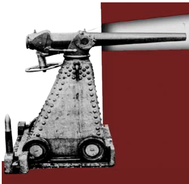
Disposición de un cañón Nordenfelt con montaje de caponera en una cañonera. La explanada es pequeña y sirve para retener las ruedas e impedir el movimiento de retroceso del cañón en el momento del disparo. En el ángulo inferior izquierdo se observa un cartucho.
