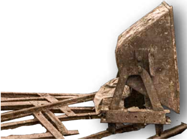
Vagoneta-volquete de una línea férrea tipo Decauville, utilizada en los movimientos de tierra durante la construcción del Fuerte.
