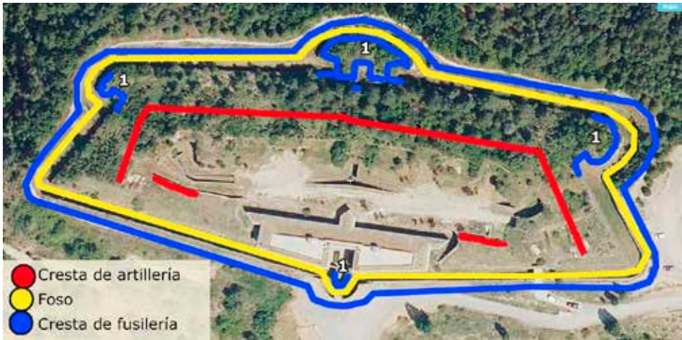
Fuerte de Rapitán. Trazado del foso y de las cresta de fusilería (camino cubierto) y artillería. 1 caponeras y semicaponeras.
