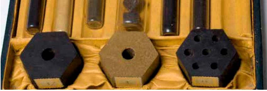
De izquierda a derecha con la pólvora negra y parda de un canal y pólvora negra de siete canales.
