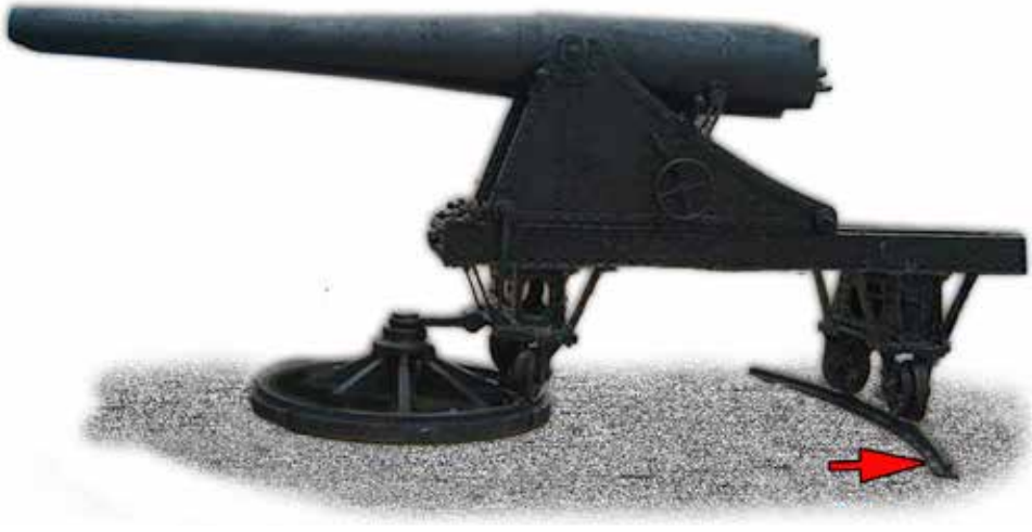
Carrilera de contera (posterior) de un Cañón de Hierro Entubado de 15 cm "Ordóñez", modelo 1885, montado sobre marco alto, similar a los que artillaron la batería a barbeta en el Fuerte de San Marcos. (Fot.:Castillo de San Cristóbal en Puerto Rico).
