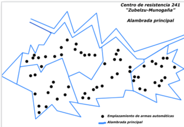
Esquema de la alambrada principal, a modo de ejemplo, de uno de los centros de resistencia guipuzcoanos de la Organización defensiva de los Pirineos. Además de esta alambrada principal existían también alambradas secundarias que requerían gran cantidad de materiales.
