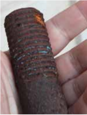
Espárrago de sujeción de la basacarril de un CHE de 15 cm a la explanada, eliminado en 2009.
