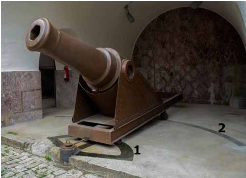
1 Carrilera de testera original (en este caso formando parte de la basacarril). 2 carrilera de contera (réplica simplificada) de un obús de hierro sunchado de 21 cm (réplica simplificada) en la batería de fuegos curvos del Fuerte.
