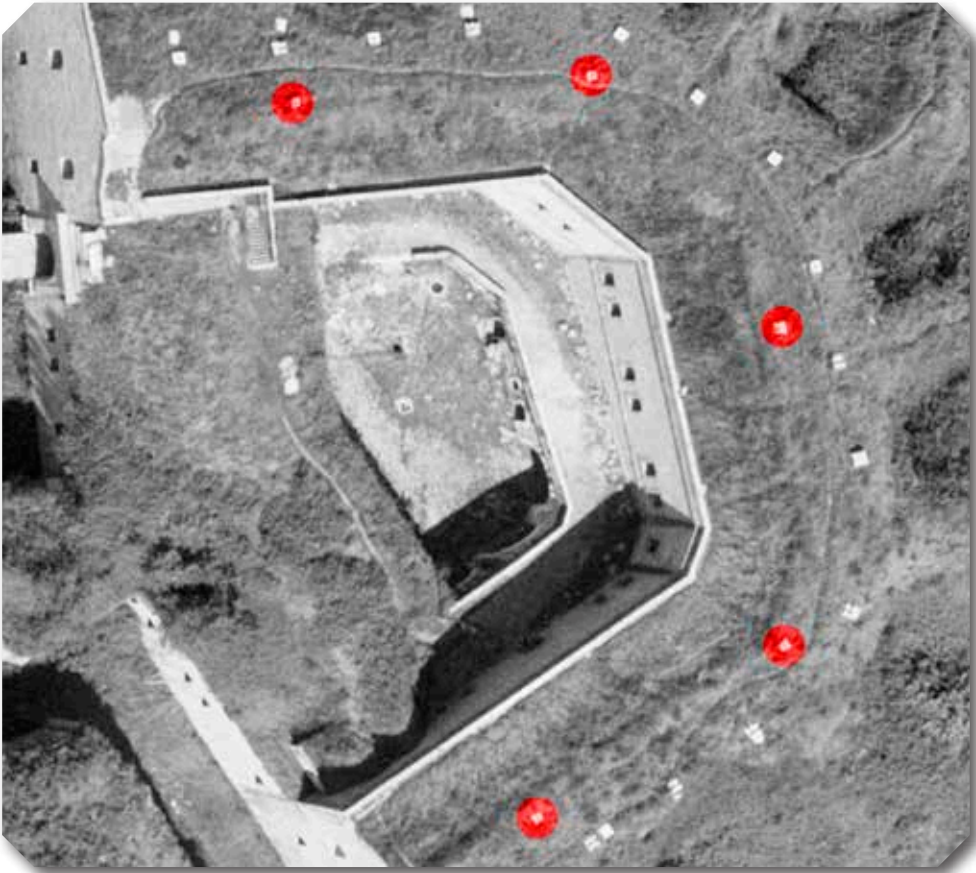
Fotografía aérea (Diputación Foral de Gipuzkoa) de 1981 en la que se han identificado los sillares de piedra caliza que sirvieron de soporte a los cinco pararrayos que poseyó el Fuerte.
