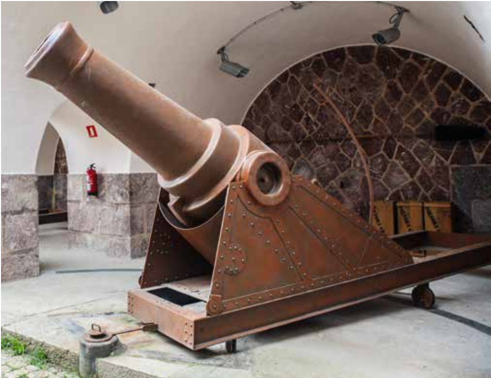
Una de las tres réplicas de OHRS de 21 cm realizadas para ambientar la batería de fuegos curvos del Fuerte. El volumen es similar al original, pero los roblones son más pequeños.
