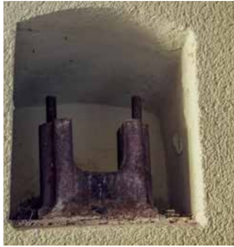
Soporte de fundición que recibía el cojinete de bronce sobre el que giraba el sistema.
