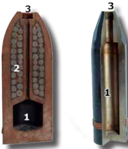
Izda. granada de metralla (shrapnel) 1: explosivo. 2. balines. 3 rosca para la espoleta. Dcha: granada-torpedo o rompedora , de principios del siglo XX.
