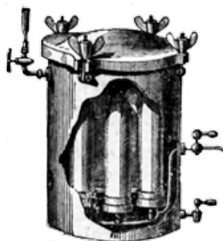
Filtro de 5 bujías de porcelana-amiante, sistema Maillé, capaz de depurar 500 litros de agua al día (B). Sus dimensiones son 25 cm de diámetro y 33 cm de altura. El material con el que estaban confeccionadas las bujías era amianto pulverizado, humedecido y amasado hasta formar las bujías filtrantes, sometiéndolas posteriormente a un proceso de endurecimiento.
