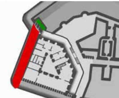
Semicapонера con tres aspilleras para fusil que flanquean el tramo de foso n. 9 y defienden también la puerta de acceso al foso del cuartel.
