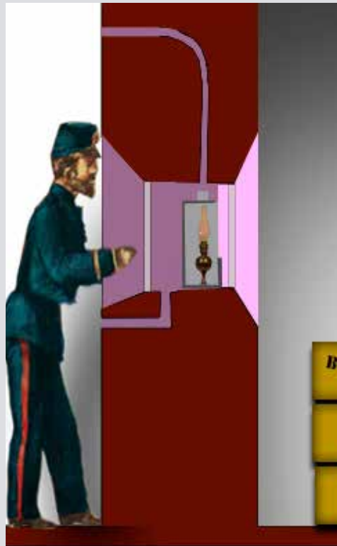
Funcionamiento genérico de una ventana de iluminación con sus conductos de aireación
